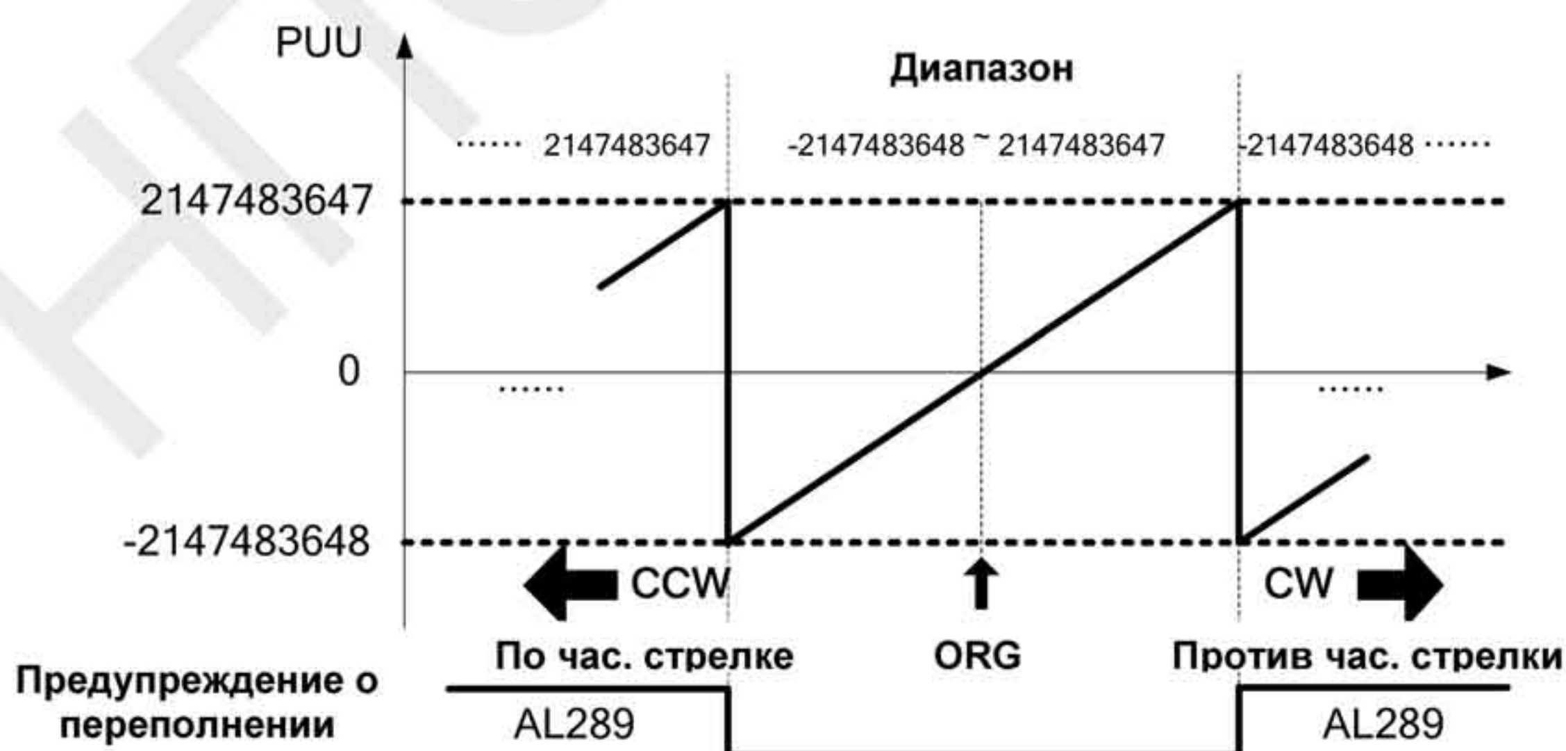
Рис. 12.2 Подсчет PUU в системе абсолютных координат
